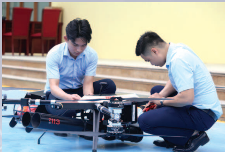
Thiết bị bay không người lái có khả năng bắn quả nổ bột, mang lương thực, áo phao cứu hộ trong công tác PCCC&CNCH
